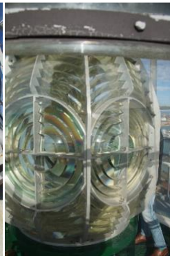
Lenti Fresnel con settore oscurato
