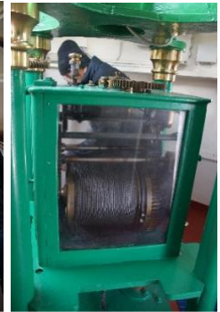
Sistema di rotazione meccanico azionato da contrappeso
