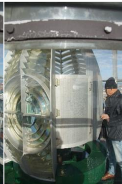
Lenti Fresnel con settore oscurato
